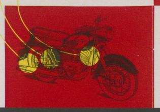
Die Vorderradbremse hat einen Durchmesser von 160 mm. Der Belag ist 25 mm breit. Durch die verrippte Bremstrommel ist die Wärmeableitung hervorragend und dadurch das "Fading" äußerst gering.
